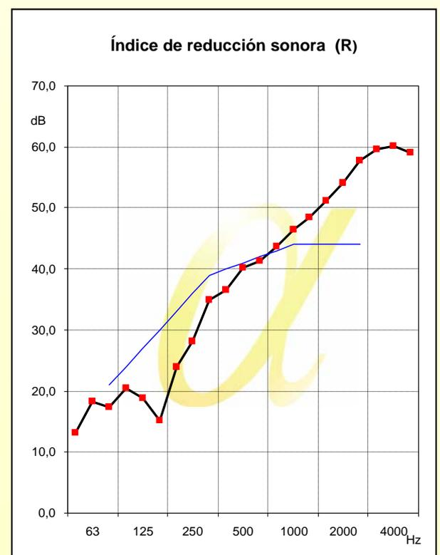
Las puertas acústicas PI son el complemento ideal de las cabinas y pantallas acústicas realizadas con este tipo de panel. El rendimiento acústico que ofrece una puerta PI es igual al rendimiento acústico de un panel AISFÓN.
